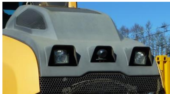
Afb. 7: Camera en extra verlichting achterop een voertuig.
